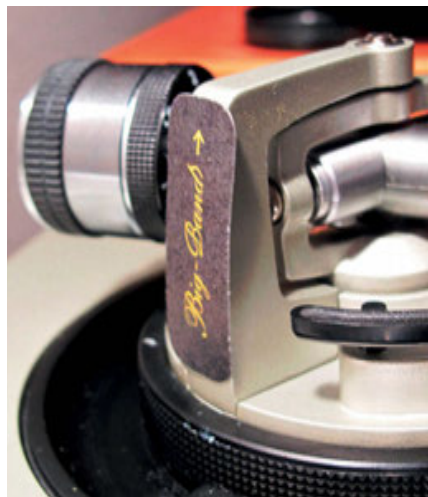
Altra Big Band applicata al ponte su cui è impernata l'articolazione del braccio Technics.
