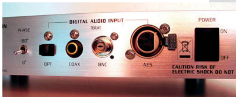
Il DAP-999EX Limited prevede un ampio impiego di standard di connessioni (TosLink, RCA, BNC, AES), più un commutatore per la fase (0°/180°).
